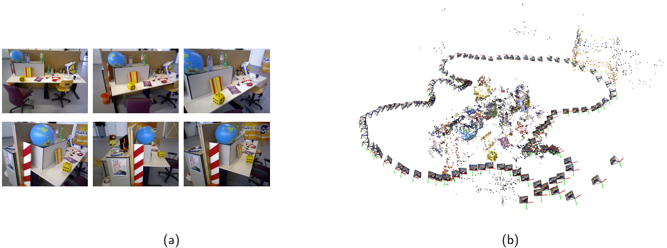
FIG. 1 – Reconstruction 3D : (1a) Exemples d'images en entrée de l'algorithme de reconstruction, (1b) Nuage de points 3D et poses des caméras estimés
